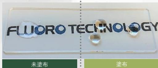
ガラス板の右側半分には8%濃度品をディッピングで塗布しています。（推定膜厚4-5μm）
